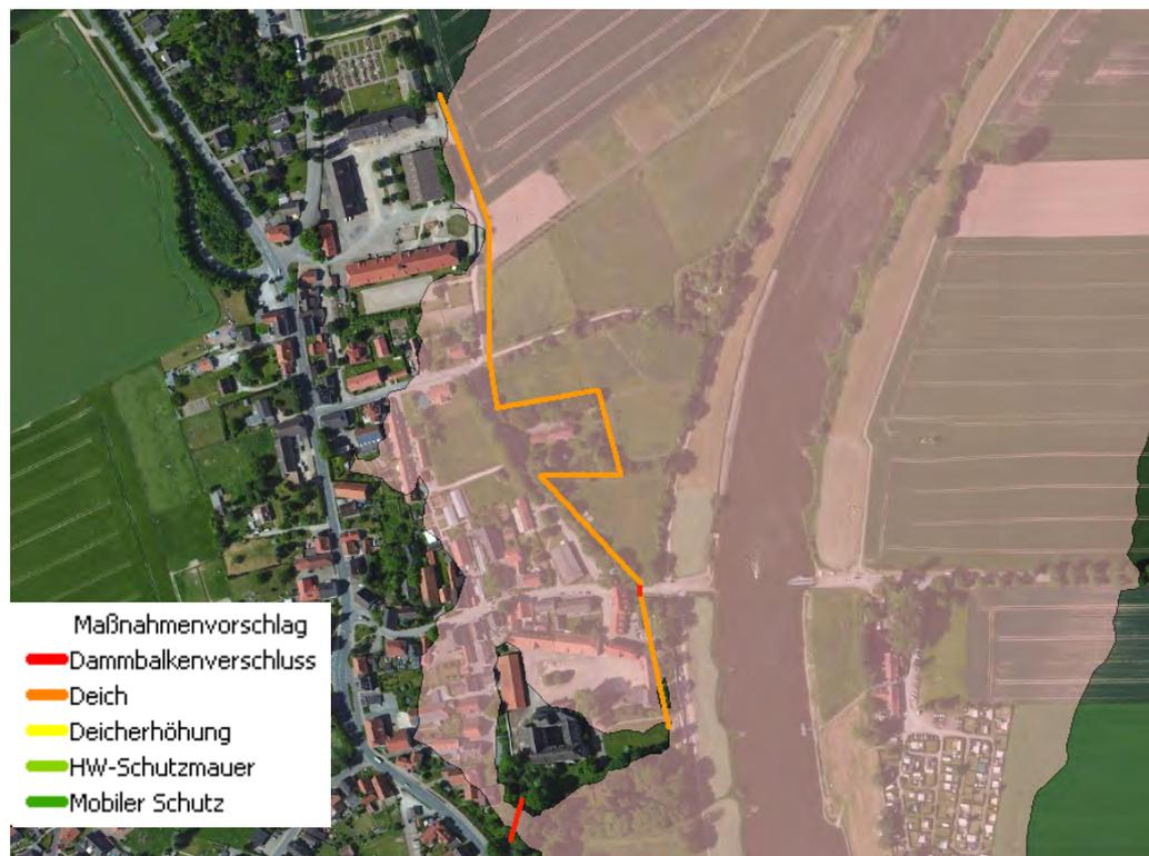
Abbildung 30: Überschwemmungsflächen HQ<sub>100</sub> und vorgesehene Maßnahmen im Bereich Grohnde
