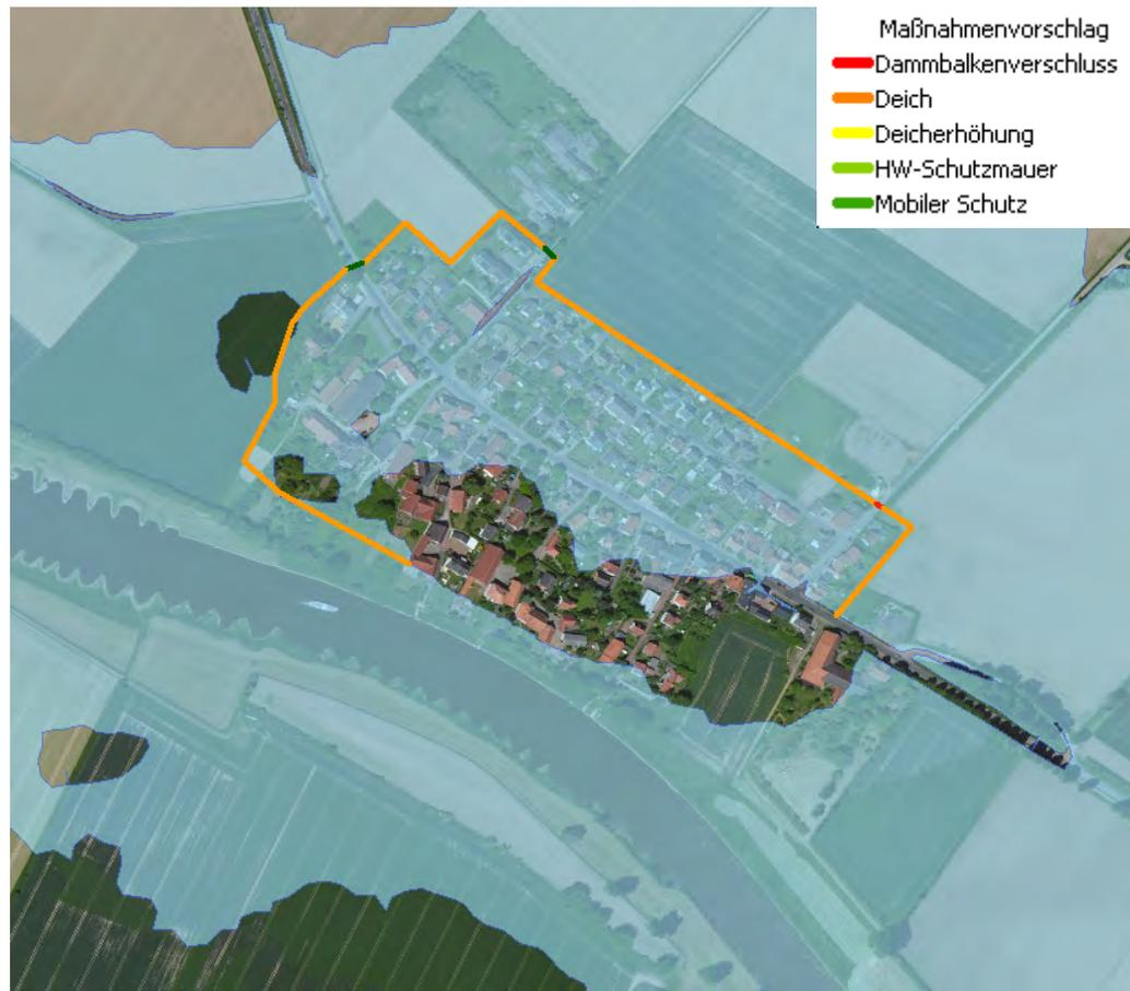
Abbildung 25: Überschwemmungsflächen HQ<sub>100</sub> und vorgesehene Maßnahmen im Bereich Wehrbergen
